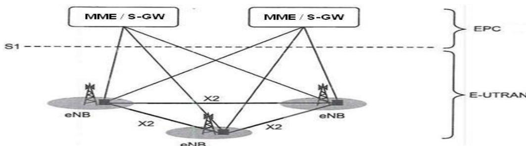
Рис. 1. Упрощенная архитектура сети LTE
