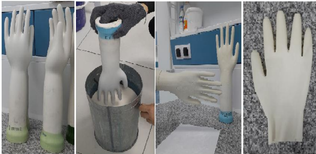
1-rasm. Tabiiy kauchuk (lateks) asosida tibbiyot qo'lgloplarini olish jarayoni.
